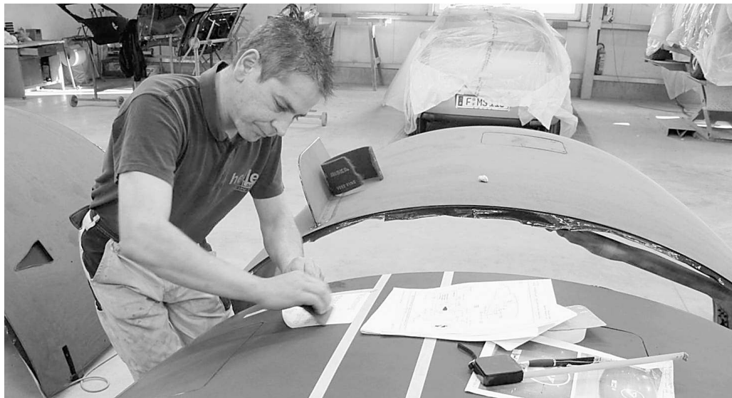
Folien auf der Triebwerkhülle: Danny Schulz muss die vielen Details der Anleitung genau beachten.
